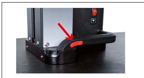
Fig. 6 Pulsante di attivazione del cuscinetto pneumostatico
